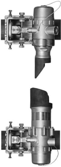
Rivelatore di gas idrocarburi a tecnologia IR Open Path. Il trasmittore ed il ricevitore sono separati e creano un raggio luminoso di campionamento ad infrarossi che può coprire una distanza dai 5 ai 120 metri. Il range di misurazione va da 0 a 5 LEIm.
